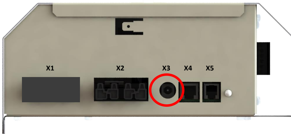
Abbildung 19: Buchse X3 Spannungsversorgung mit externer Versorgung 24 V DC
